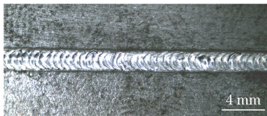
图 4 常规条件下硼钢/Q235 钢激光焊缝的表面形貌
