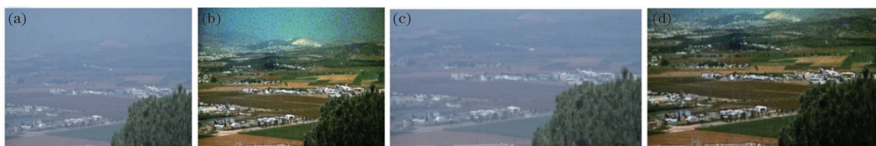
图 3 偏振去雾的实验结果对比 [37] 。天区存在时的(a)原始数据和(b) Schechner 型偏振去雾图像;天区不存在时的(c)原始数据和(d)新技术偏振去雾图像
