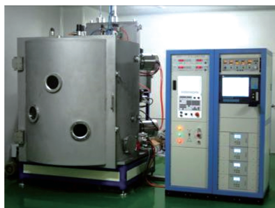
图 6 离子束加工设备与物理溅射过程示意图 [22] 。(a)离子束加工设备;(b)物理溅射过程示意图
