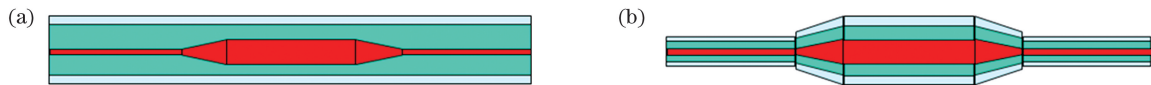
图 15 纺锤形增益光纤。(a)纤芯包层比变化;(b)纤芯包层比固定不变
