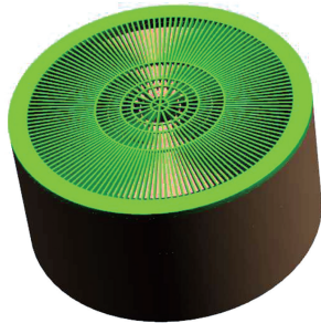
图 2 中心辐射结构冷却器的流道结构
