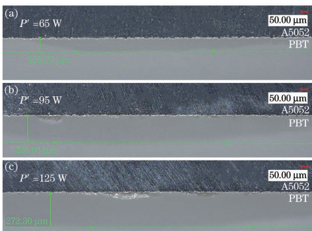
图 8 不同焊接功率下接头的横截面形貌
