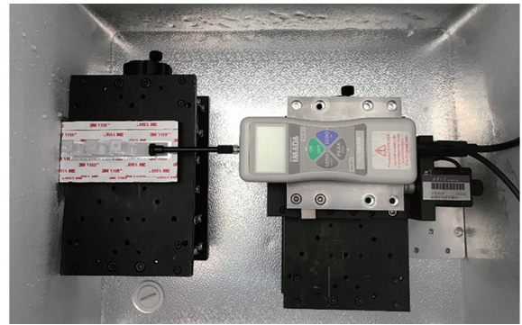
图 2 超疏水表面冰剪切强度的测试装备
