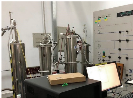
图 5 光纤温度/应变传感系统的高低温实验平台
