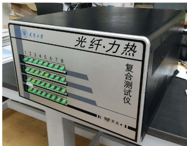
图 10 光纤力热复合测试仪的实物图
