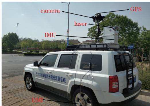
图 1 SSW 车载激光建模系统整体构成
