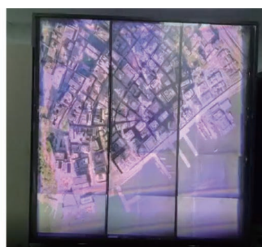
图 2 集群光场立体显示器,它由 15 个 8K 液晶面板、15 个激光源和超大幅面柱镜光栅构成
