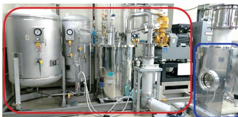
图 11 超低温氦气循环冷却系统照片 [68]
