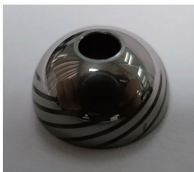
图 14 动压气浮轴承系列等角螺旋槽
