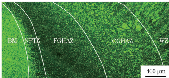
图 5 焊接接头的区域划分
