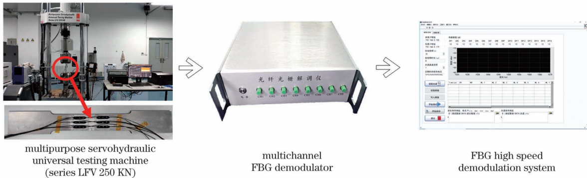
图 4 疲劳裂纹扩展 FBG 监测实验系统
