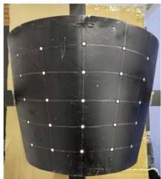
图 5 变曲率构件的实物图
