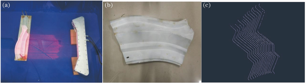
图 12 水下钣金件三维测量。(a)实验环境;(b)被测物体;(c)三维点云
