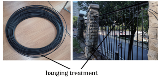
图 16 周界振动光缆挂网实验示意图
