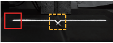
图 15 原图提取的光条中心 Fig. 15 Stripe center extracted from the original image
