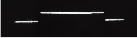
图 11 传统重心算法提取的光条中心
