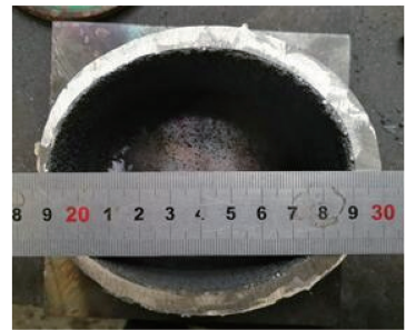
图 10 激光熔覆制造变斑熔覆工件
