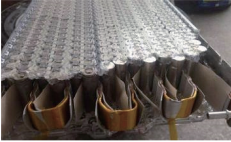
图 10 特斯拉 Model 3 电池组局部排列及电池组上的热敏电阻感温元件
