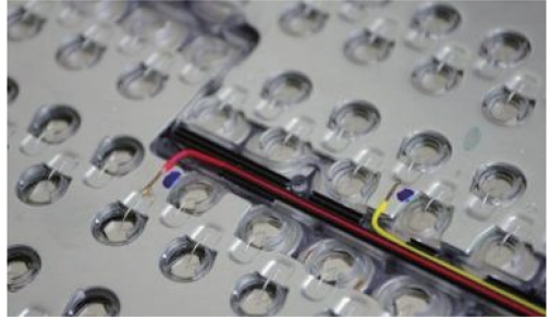
图 10 特斯拉 Model 3 电池组局部排列及电池组上的热敏电阻感温元件
