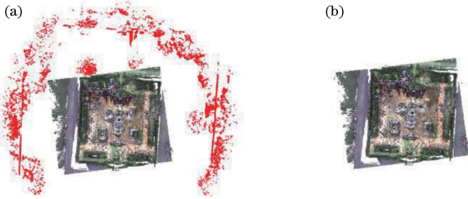
图 8 去噪前后的点云。(a)去噪前点云;(b)去噪后点云
