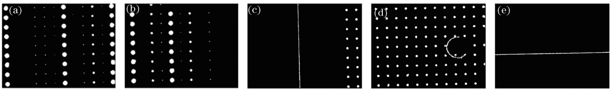
图3 静态标定结果。(a)~(d)标准粒子板再现像;(e)标准丝再现像
