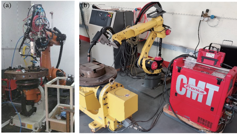
图 1 焊接设备。(a)远程激光焊接系统;(b) CMT 焊接设备
