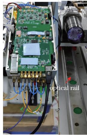
图 5 干扰抑制雷达系统与激光出射准直镜
