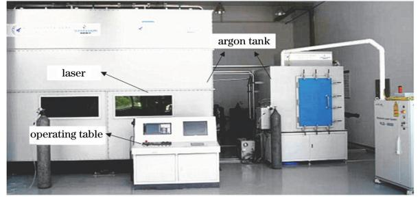
图 1 激光增材制造系统
