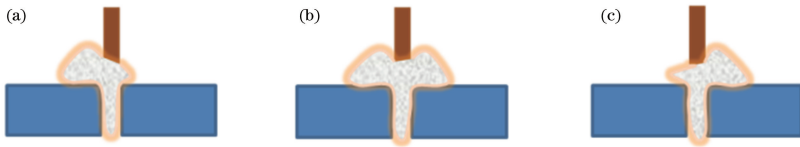
图 3 激光-MIG 复合焊电弧等离子体的三种截面形态示意图。
