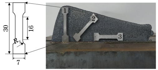
图 4 拉伸件的选取位置和尺寸
