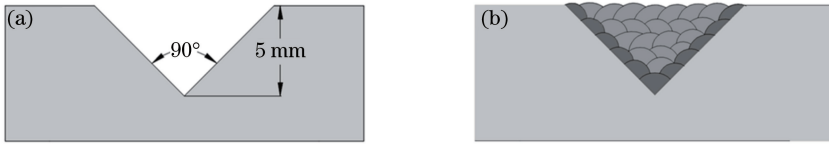
图 1 修复实验示意图。(a) V型槽;(b)模拟修复路径
