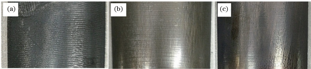
图7 不同扫描速率下得到的重熔层的宏观形貌。(a) 1 mm/s;(b) 2 mm/s;(c) 3 mm/s
