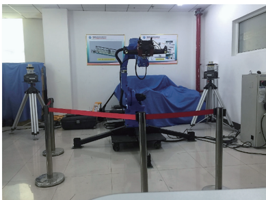
图 8 机器人测量系统
