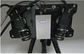
图 10 快速结构光双目系统
