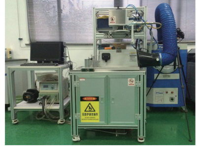
图 2 陶瓷 SLM 成形实验平台 [4]
