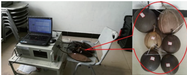
图 6 现场测试装置照片(右图为使用的橡皮采样球)
