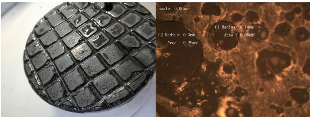
图 7 多微孔沥青抛光盘。(a)实物图;(b)光学显微镜
