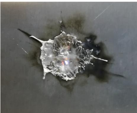
图 4 脉冲激光作用后铝合金板的烧蚀形貌
