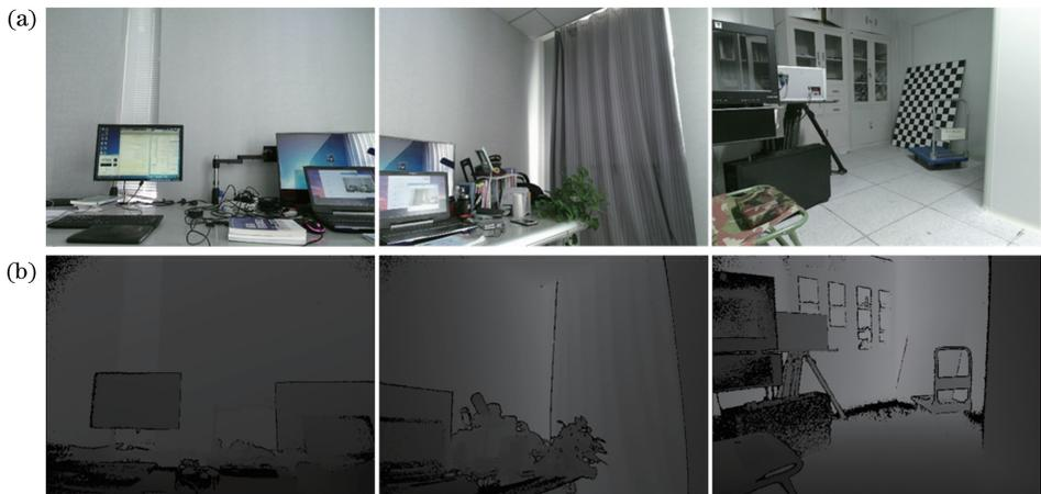
图 2 Kinect v2 传感器采集图像的配准结果。(a)彩色图像;(b)深度图像
