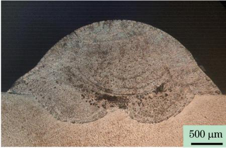
图 6 熔覆层的横断面形貌
