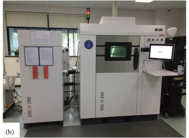
图 2 (a) 基于粉末床的 SLM 技术示意图; (b) EOS M290 选区激光熔化设备
