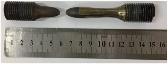
图 12 焊接接头的高温拉伸试验
