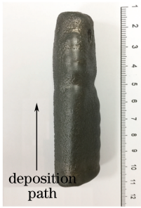
图 2 成形试样形貌
