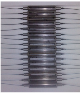
图 9 DFB 光纤激光水听器原型样品
