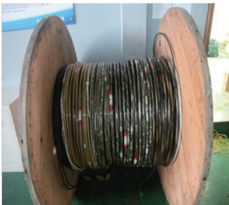
图 10 DFB 光纤激光水听器拖曳阵
