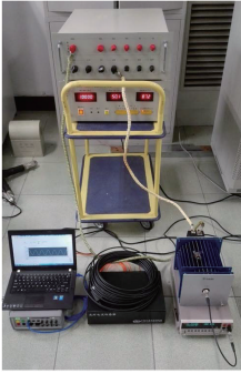
图 6 DC FOCT 谐波测量准确度测试平台
