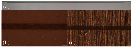
图 11 不同材料接收到的线光斑照片。(a)热敏相纸接收到的线光斑;(b)光学显微镜下热敏相纸接收到的局部线光斑; (c)光学显微镜下表面氧化发黑处理过的铝件接收到的局部线光斑
