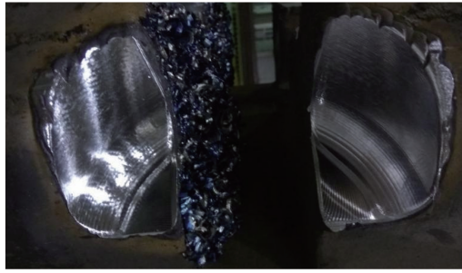
图 15 铣削加工后的链轮表面形貌
