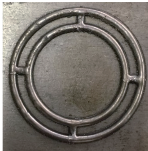
图 8 带筋双层薄壁件截面熔覆形貌
