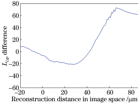
图 7 y_2 - y_1 = 0.68 \mu\text{m} 时测得的光程长差分变化图
