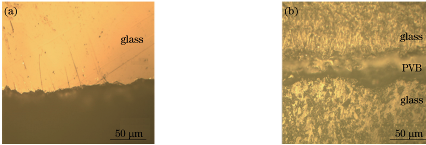
图 9 传统机械切割方法的分离效果图。(a) 200 倍下的边缘切口;(b) 200 倍下的 PVB 胶层
