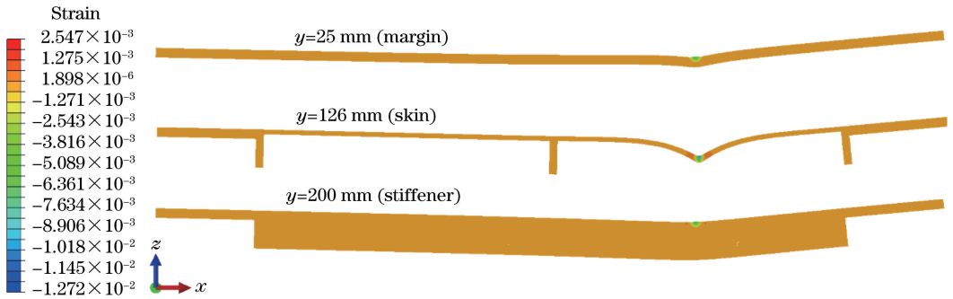
图 10 不同位置的横向弯曲变形(变形放大 30 倍)
