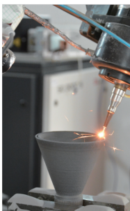
图 10 小间隙双层斜套加工过程
