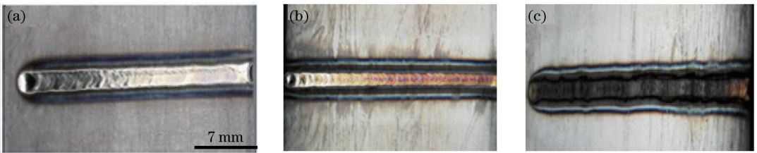
图 13 不同喷嘴直径保护下的焊缝外观形貌。(a) \Phi=10 mm; (b) \Phi=4 mm; (c) 无保护
